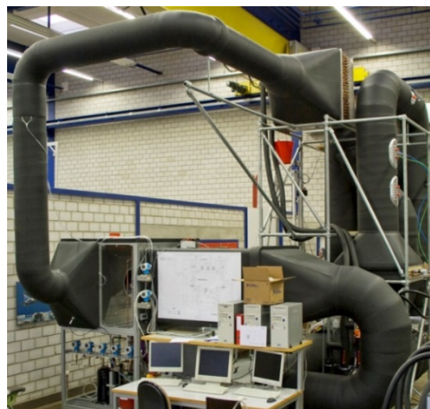
L/W-WP-Prototyp (links) und Luftaufbereitungsanlage mit L/W-WP-Prototyp (rechts) an der Hochschule Luzern
